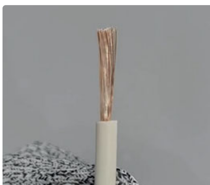
CONDUCTOR DE ALUCOBRE (SE HACE BLANCO AL RASPARLO)
