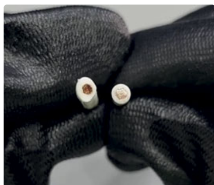
AISLAMIENTO MAL CENTRADO
