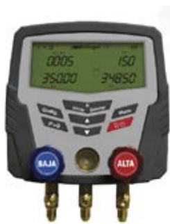
Presión del refrigerante menor a 100 PSI con temperatura ambiente de 35 °C
